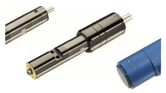
I motori MUB23 sono dotati di freno che tiene bloccato il motore quando non è alimentato. Non è necessaria una linea aria dedicata al freno, esso funziona in automatico, si sblocca quando il motore viene alimentato e si aziona quando viene interrotta l'alimentazione aria. La forza massima di frenatura è equivalente alla coppia di avviamento.
