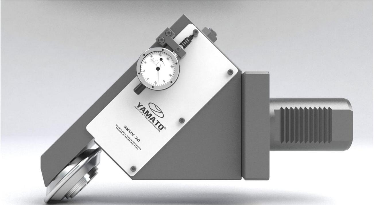
Lo SKUV30 è studiato per applicazioni di rullatura pesante di superfici e raggi di raccordo su particolari soggetti ad elevati carichi come assali, assili, alberi di trasmissione, alberi di turbine per generazione, ecc. Lo SKUV30 arriva a sviluppare oltre 7KN di pressione nell'utilizzo con adattatore a 90° e oltre 4KN nell'utilizzo con adattatore a 45°, con una lunga durata del rullo.
