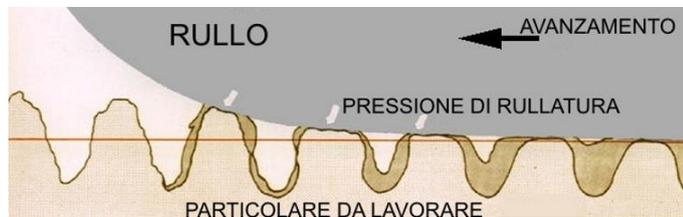
Ogni superficie lavorata con utensili ad asportazione di truciolo ha una tipica finitura influenzata dalla geometria del tagliente e dall'avanzamento. La qualità, la rugosità e la durezza della superficie sono notevolmente migliorabili con la rullatura. La rullatura è una lavorazione senza asportazione di materiale con la quale la rugosità della superficie viene diminuita grazie alla deformazione plastica del materiale data dalla pressione esercitata dai rulli.
