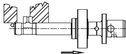
4. (SOLO Mod. 5200 – 5600) Avanzamento rapido per l'avvicinamento alla superficie frontale, lavorazione alla velocità consigliata e breve sosta per ripulire il taglio (1-3 giri).
