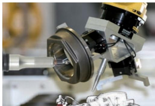
**engraflexx AP** impiegato per la sbavatura del pezzo con robot
