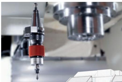
**engraflexx EC** impiegato sul centro di lavorazione, con cambio d'utensile automatico tramite cambiautensili
